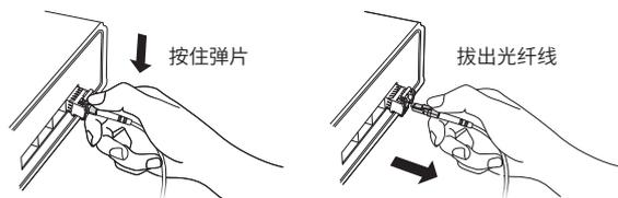
2、将光模块锁扣扳下，手拉住拉环，将光模块平行拔出。
